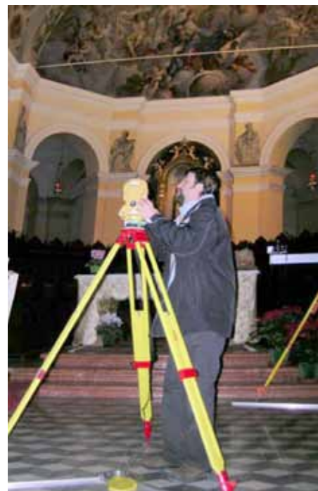
Rilievo della rete topografica di appoggio alla scansione laser.
