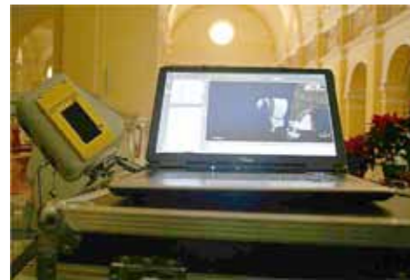
Il laser a scansione nella fase di acquisizione, con visualizzazione in tempo reale del dato su personal computer. È chiaramente visibile sullo schermo la linea di scansione corrente.
