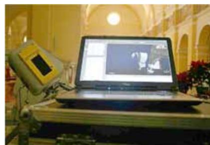
*Il laser a scansione nella fase di acquisizione, con visualizzazione in tempo reale del dato su personal computer. E' chiaramente visibile sullo schermo la linea di scansione corrente.*
